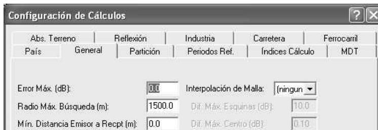
Ilustración 16. Configuración de los cálculos. Distancia de propagación del sonido desde la carretera. Fuente: Elaboración propia
