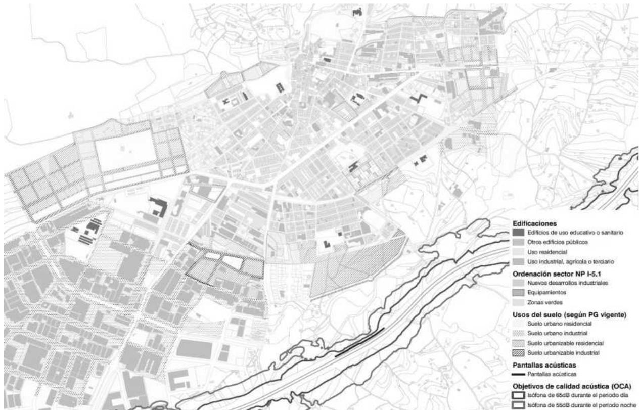
Ilustración 6. Delimitación del área de superación de los Objetivos de Calidad Acústica en el municipio consecuencia del tráfico en la A-7. Fuente: Elaboración propia
